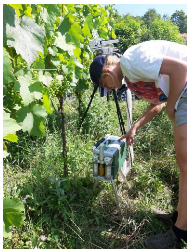
Slika 7: a) - Naprava za meritve fizioloških parametrov in procesov LI-6400 (Licor, ZDA) (neto fotosintezo, dejansko in potencialno fotokemično učinkovitost PSII, prevodnost listnih rež, transpiracijo ter b) Naprava za meritve vodnega potenciala vinske trte t.i. Scholanderjeva tlačna komora.
